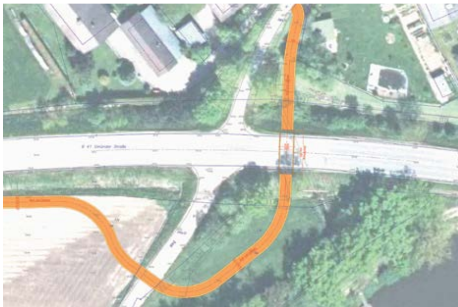
Die geplante, geprüfte und nun genehmigte Unterführung der B 41 war die erste Hürde des Projektes Radweg Dietmanns - Gmünd. Sie wird vor dem Ehrendorfer Teich die B 41 queren und in die Flurgasse einmünden.
